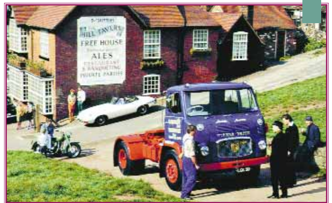
Ce Scania Vabis LB76 fut produit de 1963 à 1968. Il est le premier tracteur à cabine avancée de conception moderne pour les transports internationaux. Ici, la version Super de 1966, dotée d'un moteur à injection directe suralimenté, ce qui fournit au moteur DS11 une puissance de 240 ch. Le modèle britannique avec conduite à droite, produit à 4 693 exemplaires, permit aux Suédois de s'implanter en Grande-Bretagne.
