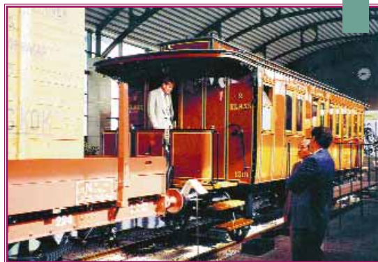
Ce wagon, divisé en deux compartiments de 3 e classe et un de 2 e , fut l'une des premières productions de ce qui allait devenir Scania 100 ans plus tard. Il est doté de Bogies pour voies étroites.
