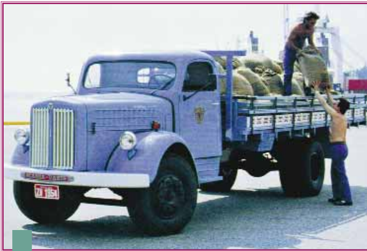
Le Scania-Vabis L65 de 1949 a vu l'apparition du premier moteur diesel à injection directe. Il sera proposé en quatre et six cylindres. Ce camion est le premier à avoir été importé au Brésil en 1951, d'où il a été réimporté et restauré pour le musée.
