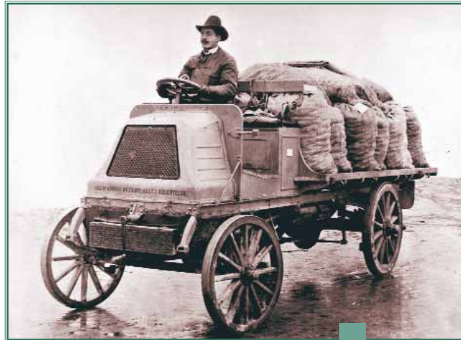
Ce camion Vagnfabriks-Aktiebolaget de 1903, est, avec le Scania 1902, le plus vieux camion suédois. Pesant 1,5 t, il roulait à 12 km/h, une performance remarquables à une époque où les chevaux tiraient une charette de 1 t à 5 ou 6 km/h.
