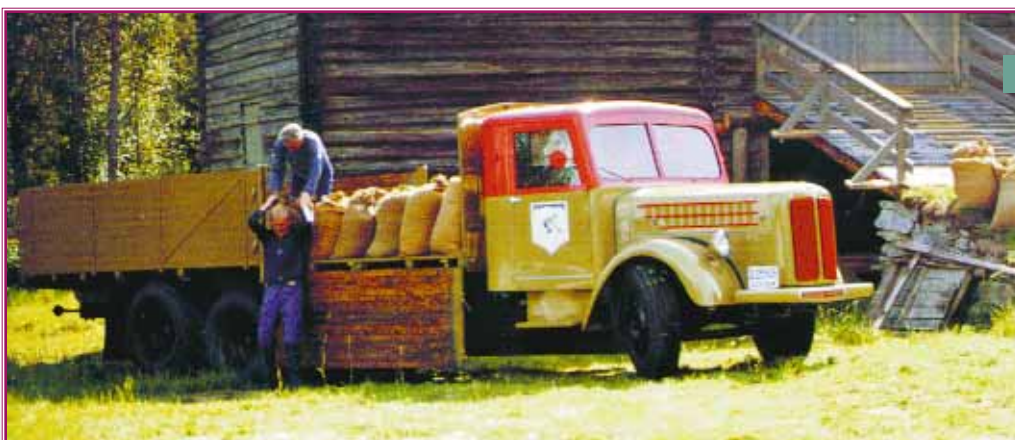
Le LS123 de 1948 est doté d'un moteur quatre cylindres et d'une chambre de précombustion, développant 90 ch ; sa boîte à 4 rapports est non synchronisée, ses freins sont à assistance par dépression. Pour un PTAC de 11,4 t il offrait 6 t de charge utile.
