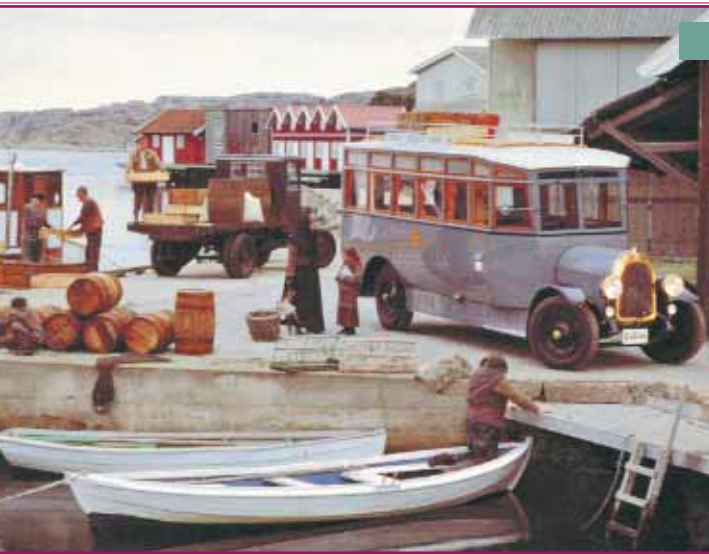
Cet autocar des années 20 est l'un des best-sellers de Scania Vabis. Pour le faire circuler en hiver, les postes suédoises garnissaient bien sûr ses roues arrière de chaînes. L'essieu avant quant à lui était équipé de skis qui permettaient de diriger le véhicule même dans la neige profonde.
